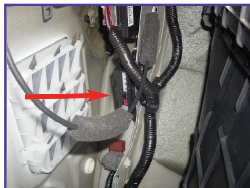
**SEGNALATORE ACUSTICO** : Inserire il buzzer tra la griglia ed il coperchio plastico presente nel rivestimento all'interno del baule lato guida.
