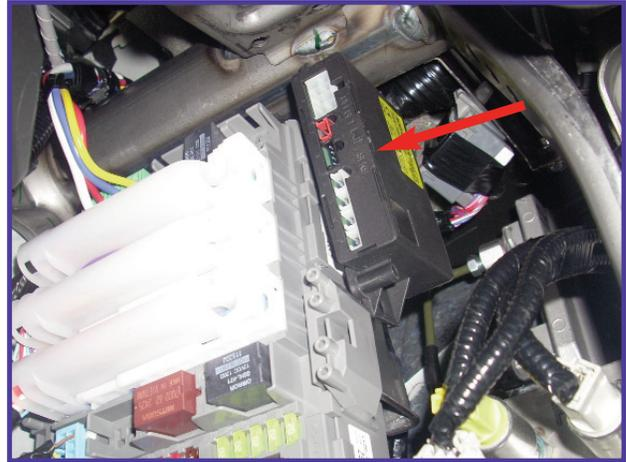
**SEGNALATORE ACUSTICO:** Posizionare il buzzer sotto al cruscotto lato guida. Per il fissaggio, utilizzare il velcro in dotazione.
